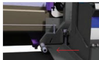
Parafuso de ajuste, situado na parte inferior esquerda da cabeça de impressão.
